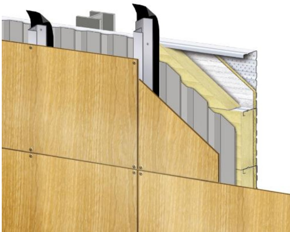
Figure 1 – Schéma de principe panneaux avec pare-pluie métallique
