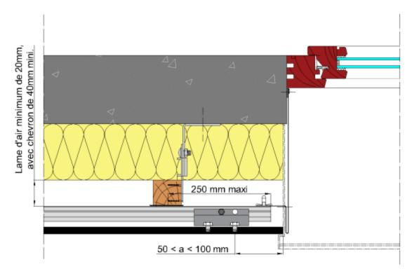
Figure 25 - Tableau de baie : solution avec façonné métallique
