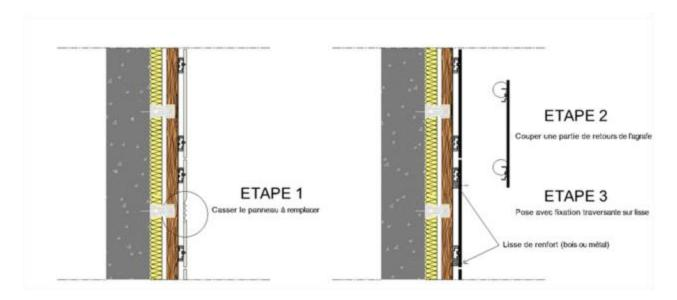
Figure 14 - Remplacement d'un panneau
