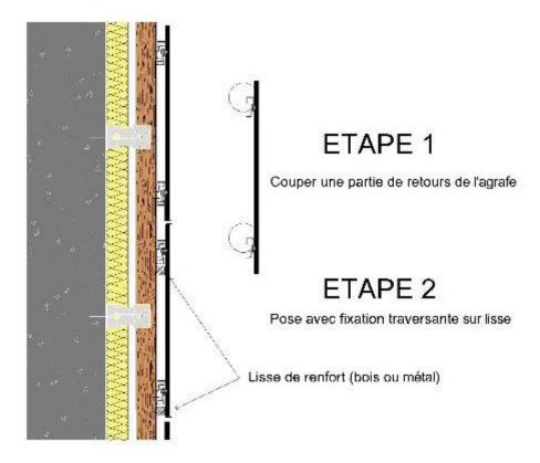
Figure 14bis - Démontage d'un panneau pour un ancrage d'échafaudage
