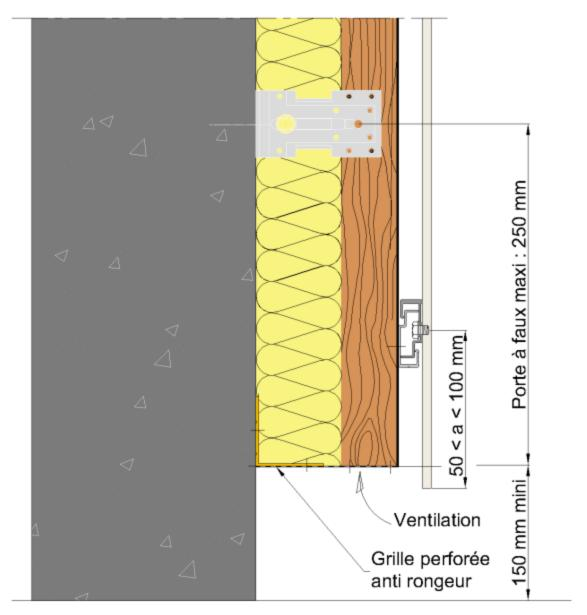
Lame d'air minimum de 20mm, avec chevron de 40mm mini.
