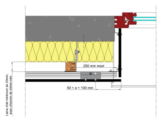
Figure 26 – Tableau de baie : solution avec panneau EQUITONE(fixation visible selon documentation en vigueur)
