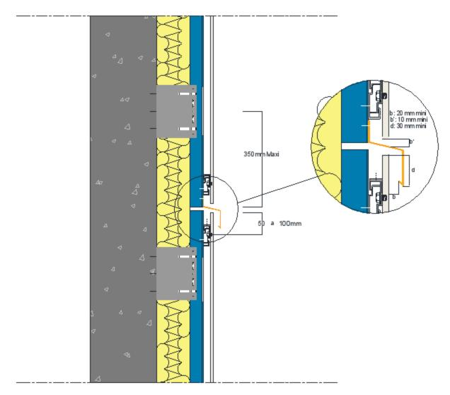
Figure 46 - Fractionnement de l'ossature : montant en aluminium de longueur entre 3 et 6m
