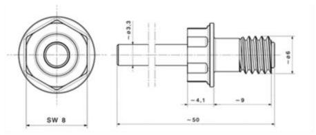
L = 9 mm pour tous les panneaux Agrafe = 3,5 mm Profondeur d'ancrage = 5.5 mm pour panneau de 8 mm
