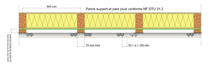
Figure 47 - Coupe horizontale sur COB
