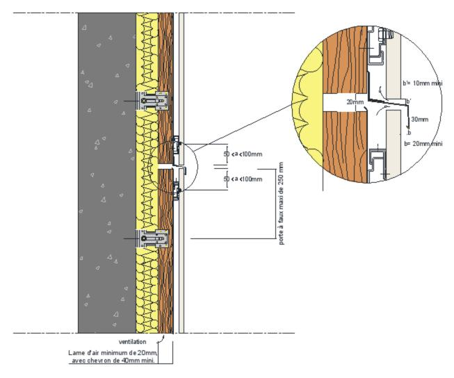
La distance entre la fixation de l'agrafer et le bout du chevron doit être 6 fois le diamètre de la fixation minimum
