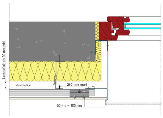
Figure 41 - Tableau de baie : solution avec façonné métallique
