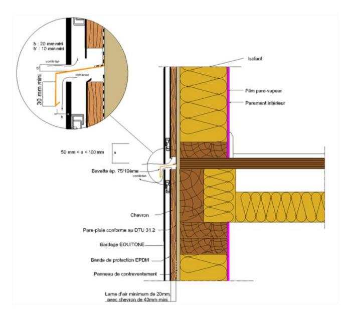
Figure A3 – Fractionnement de l'ossature au droit de chaque plancher sur COB – avec recoupement de pare-pluie
