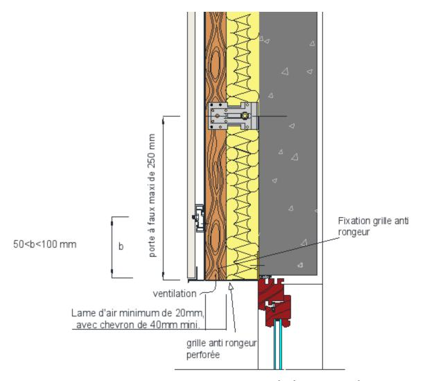
Figure 22 - Linteau de baie : solution avec façonné métallique perforé
