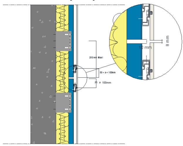
Figure 45 - Fractionnement de l'ossature (profilé acier < 6 m ou aluminium <3 m)
