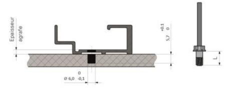
Figure 2 – Préperçage des panneaux
