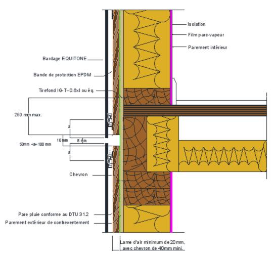
Figure A2 – Fractionnement de l'ossature au droit de chaque plancher sur COB – sans recoupement de pare-pluie
