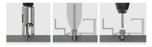
Figure 6 -Rivet TUF et rivetage des agrafes au dos des panneaux
