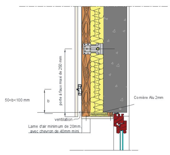
Figure 23 -Linteau de baie : solution avec panneau EQUITONE (fixation visible)
