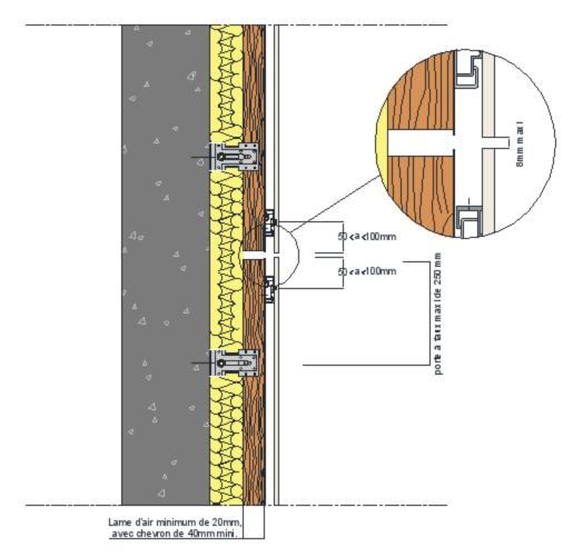
Figure 29 - Fractionnement de l'ossature bois de longueur < 5,40 m  $\,$
