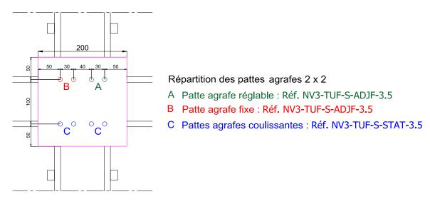
Figure 12 - Entraxes minimums et dimensions du plus petit format de panneau
