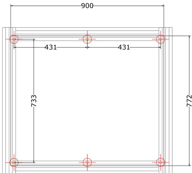
**Figure E - Distance entre fixations sur 2 appuis**
