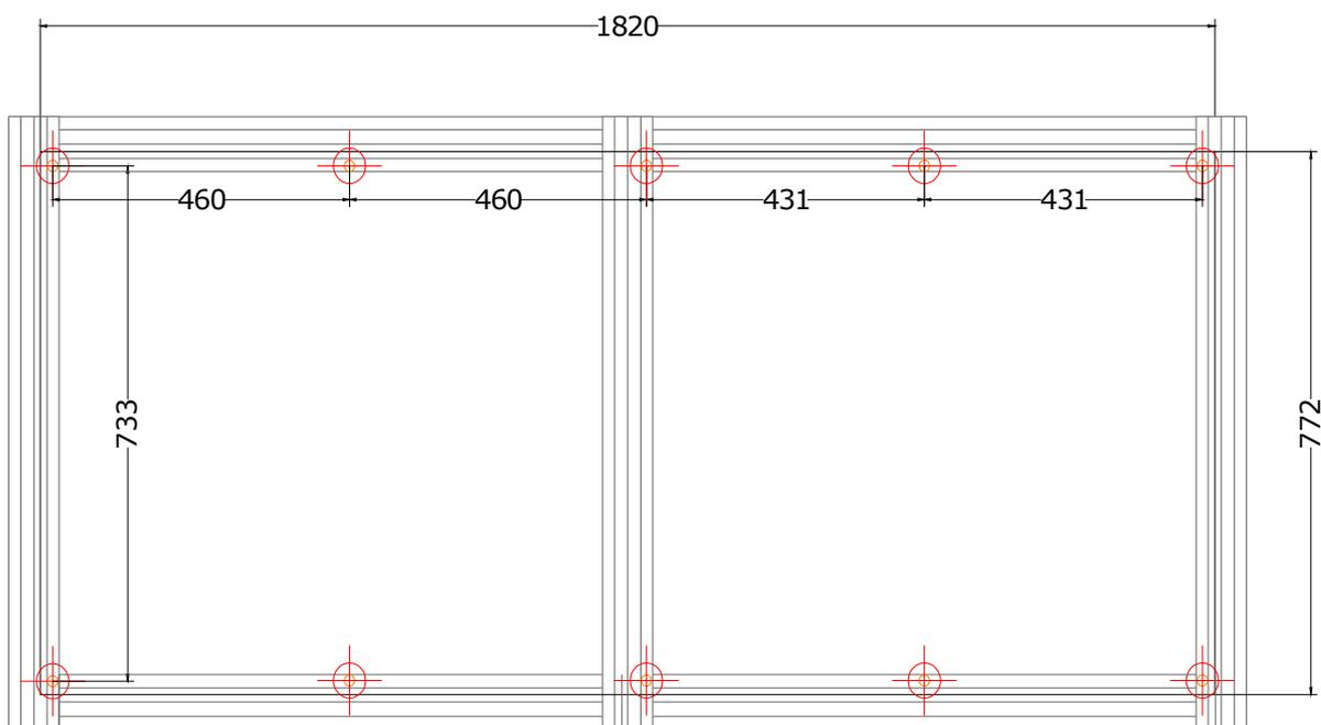
**Figure F - Distance entre fixations sur 3 appuis**
