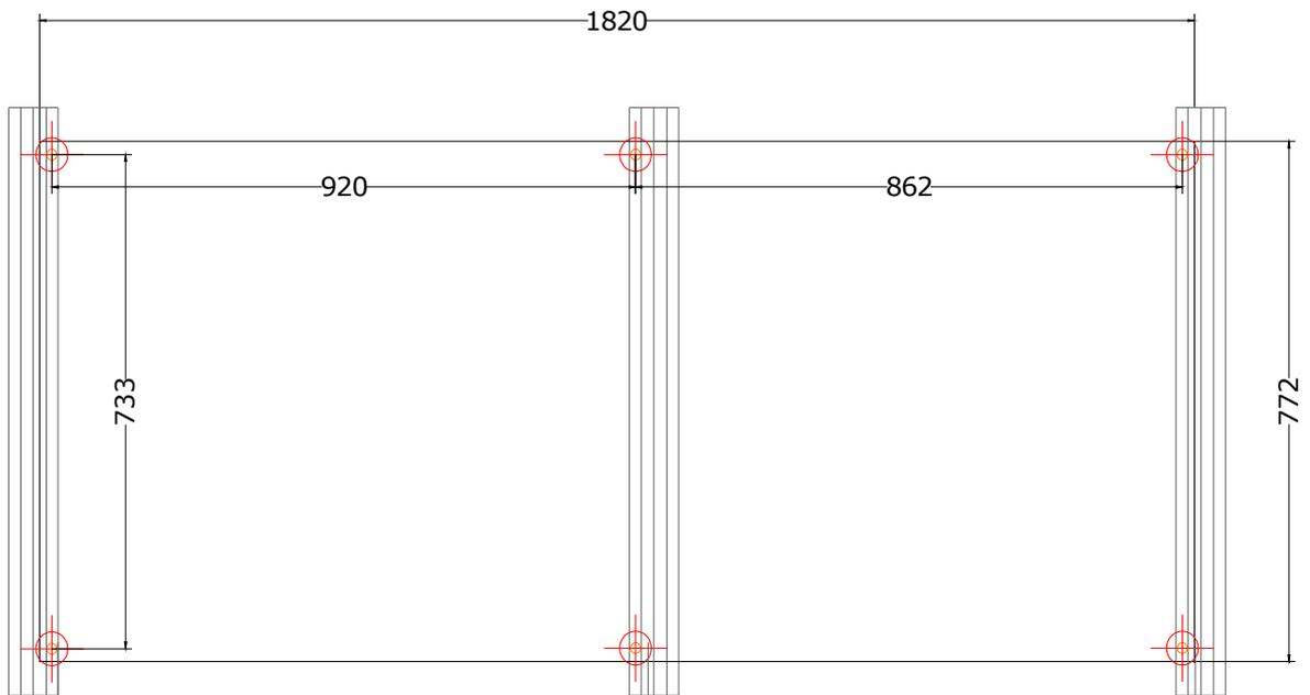
**Figure D - Distance entre fixations sur 3 appuis**
