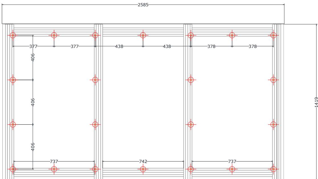
**Figure A - Distance entre fixations sur 4 appuis**
