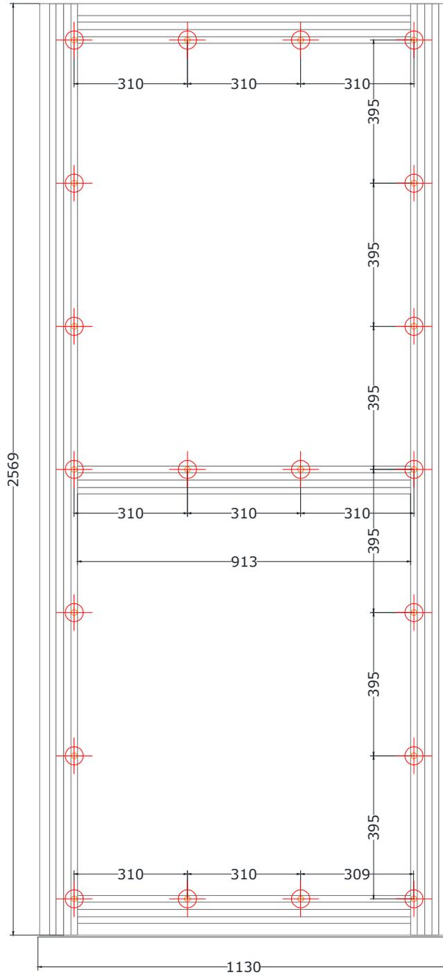
**Figure B - Distance entre fixations sur 3 appuis**
