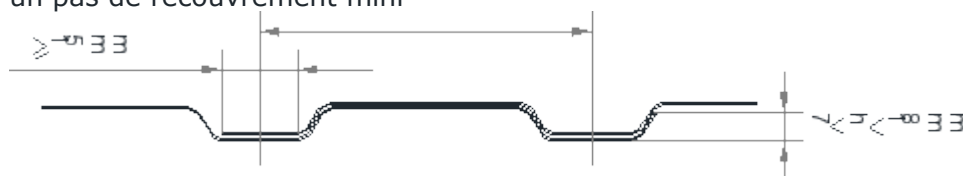
Figure 4bis – Retour minimal des tôles nervurées
