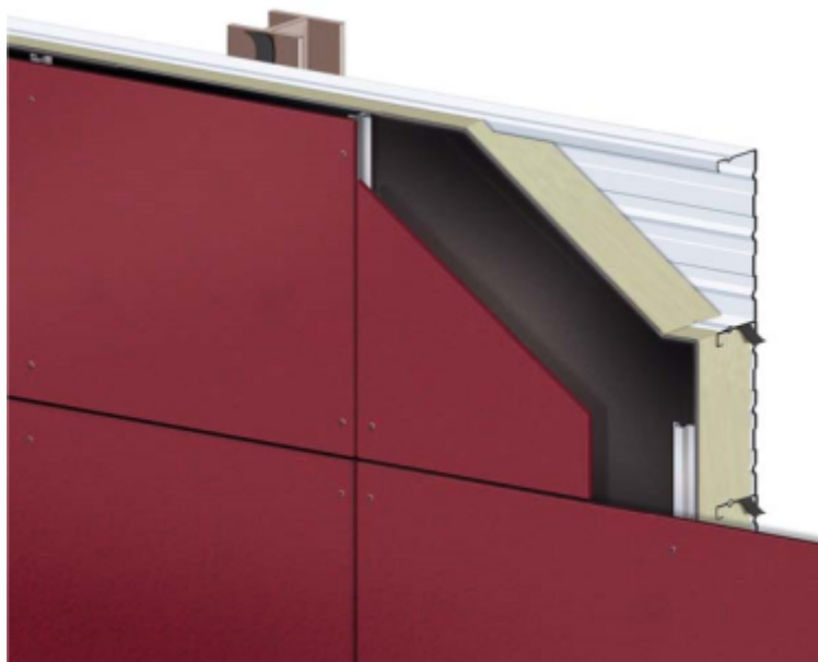
Figure 2 – Schéma de principe avec membrane de protection DELTA FASSADE 20 PLUS
