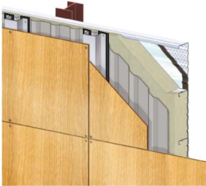
*Figure 2 – Schéma de principe avec pare-pluie synthétique*
