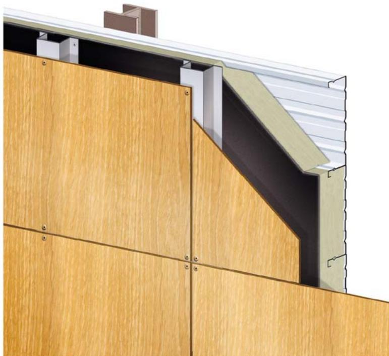
Figure 3 – Principe de pose avec pare-pluie métallique
