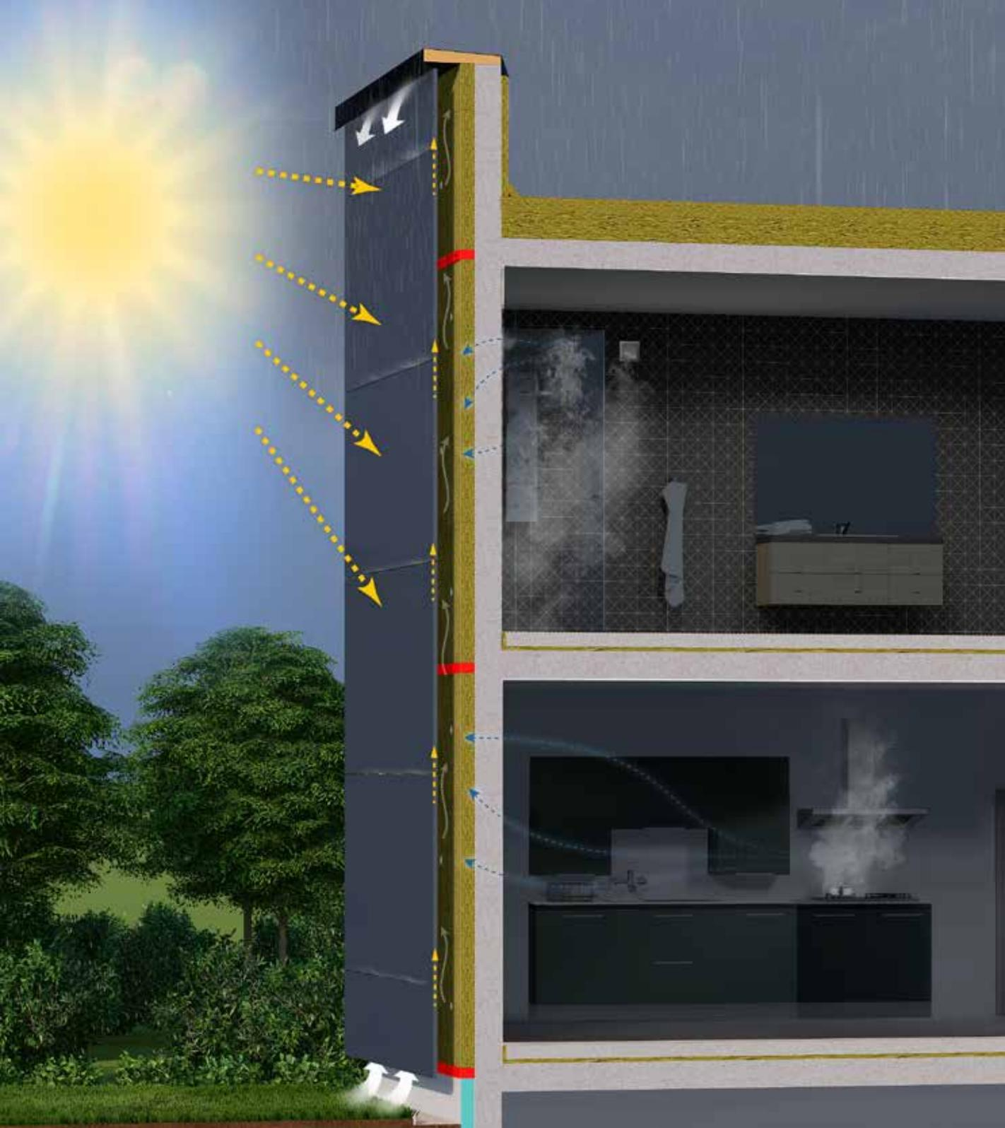
Ce principe constructif facilite l'**accès aisé à la façade** et au complexe intérieur. Il est aussi possible de dissimuler les évacuations des eaux de pluie et autres éléments derrière les panneaux de revêtement. Un aspect très pratique pour l'entretien ou le changement de panneaux dégradés.
