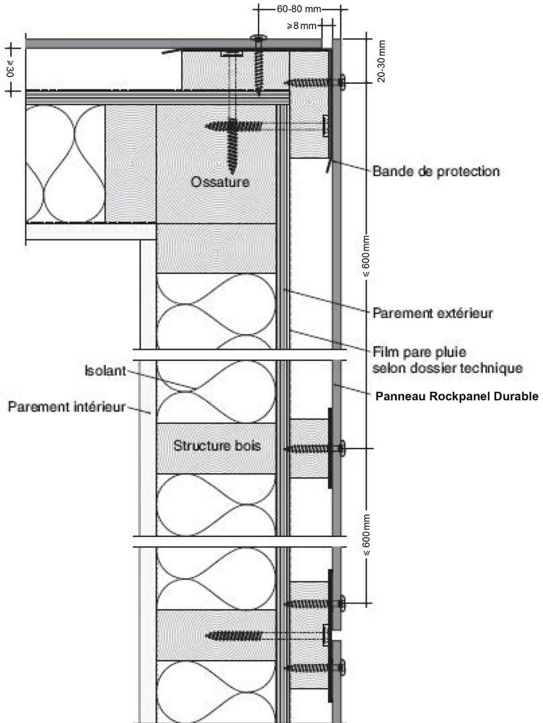
Figure 10 – Joint horizontal fermé COB supérieure à 10 m
