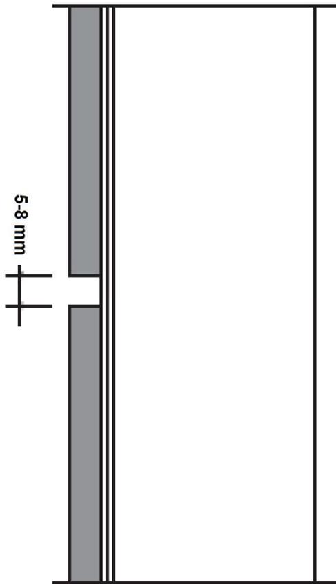
Figure 3 – Coupe verticale sur joint horizontal (joint fermé)
