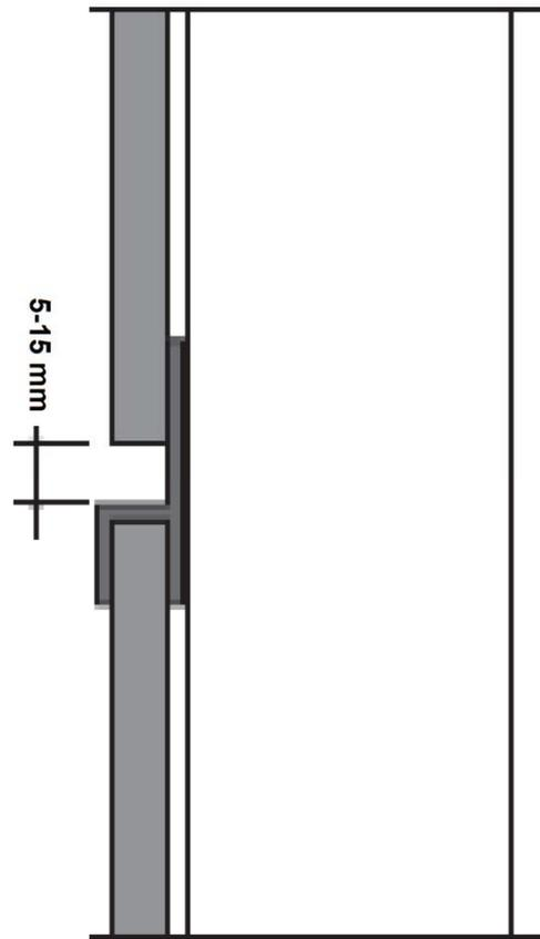
Figure 4 – Coupe horizontale sur appui intermédiaire
