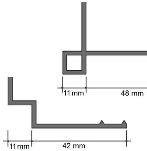
Figure 7 – Exemple de profils utilisables joint horizontal
