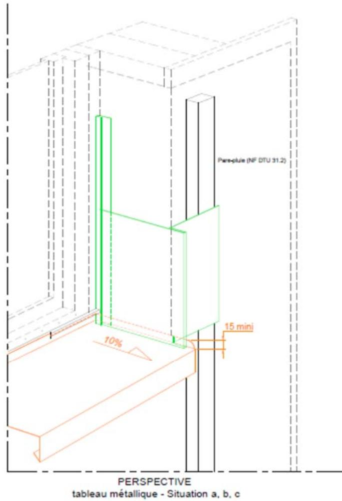
Figure 16 – Menuiserie en tunnel extérieur – Coupe sur appui de baie
