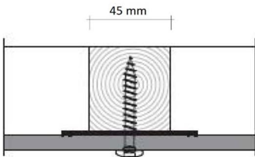
Figure 5 – Coupe horizontale sur joint vertical
