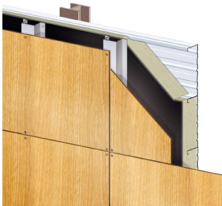
Figure 2 – Schéma de principe avec pare-pluie synthétique
