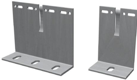
Les équerres aluminium sont conçus pour permettre une interface réglable entre la structure porteuse (Béton, Maçonnerie, Structure bois ou acier, ...) et l'ossature verticale des bardages ventilés. Celle-ci permettent une excellente stabilité de la façade sous les charges de vent et poids tout en étant conforme aux différents Avis Technique et cahier du CSTB.
