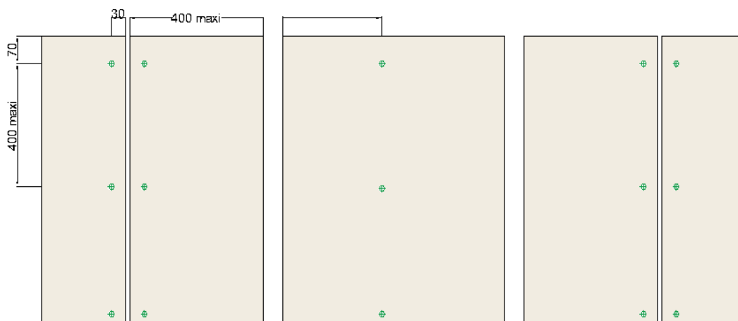
Figure 41 – Principe de la pose en sous-face
