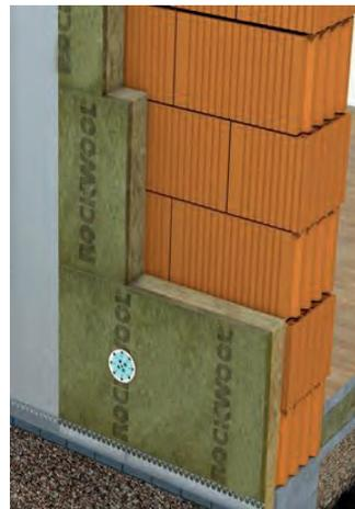
marquage superficiel. Ils doivent être posés à joints décalés, bien jointifs et fixés à raison de 2 chevilles avec collerette de diamètre 50 mm, par panneau, ou conformément aux dispositions de l'Avis Technique du système le cas échéant.
