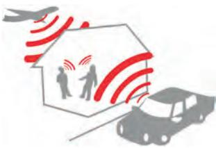
L'isolement au bruit aérien représente la différence de niveaux sonores de part et d'autre d'une paroi. Les pièces principales des logements doivent recevoir un isolement aux bruits aériens extérieurs
